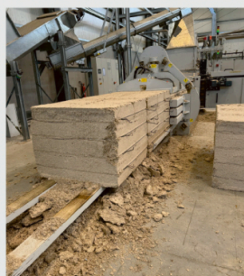
Endprodukt Faserstoffballen: Fremdstoffanteil < 0,5 %; Opt. 1: Faserstoffballen (Trockengehalt > 70 %); Opt. 2: Krümelstoff (Trockengehalt > 40 %)
