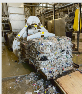
Endprodukt Rejektballen: Restfaseranteil < 5 %; Trockengehalt > 60 %
